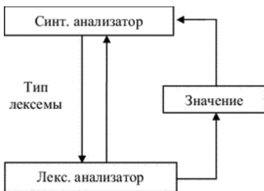
Рис. 5. Лексический анализатор как подпрограмма, работающая по принципу «дай лексему».
